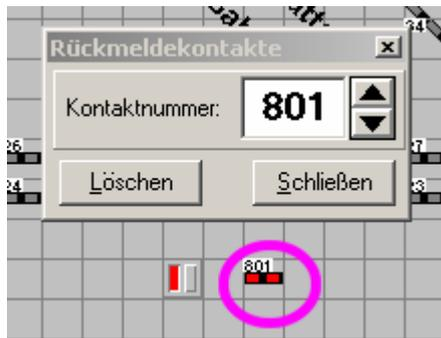
Im Gleisbildeditor nun dem Gleisstück eine RMK-Nummer aus dem in Schritt 2 vergebenen Bereich geben. Natürlich muss die RMK-Nummer zur MA-Adresse aus Schritt 3 passen, in unserem Fall ist das die 801 (Adresse 0/Anschluss 2 dann RMK 802 bis zu Adresse 3/Anschluss 8 = RMK 832 in diesem Beispiel)
