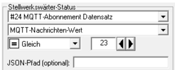
2. Berechnung Stellwerkswärter-Status -> Auswahl des zuvor angelegten MQTT-Abonnement-STWs und dann „MQTT-Nachricht-Wert“ analog zu 1.
