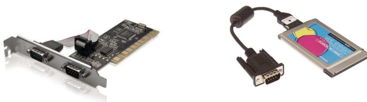
Voorbeeld van een PCI-insteekkaart (links) en PCMCIA seriële adapter voor de Laptop (rechts).
