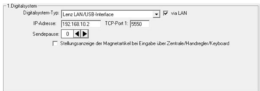
Abb. 3.43 Einstellungen für das LAN/USB Interface im Netzwerk
