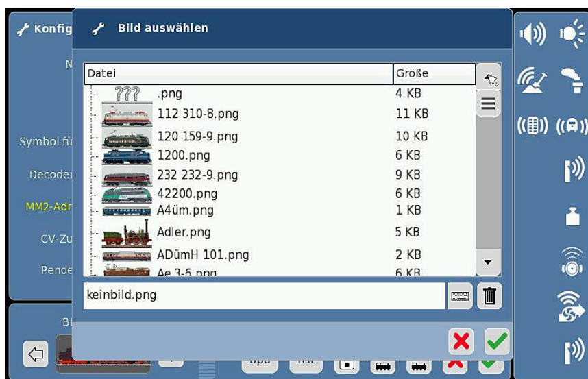
Abb. 4.7 Bilder von einem USB-Stick in eine Central Station 2 übertragen (Screenshot zeigt die Oberfläche der CS2)
