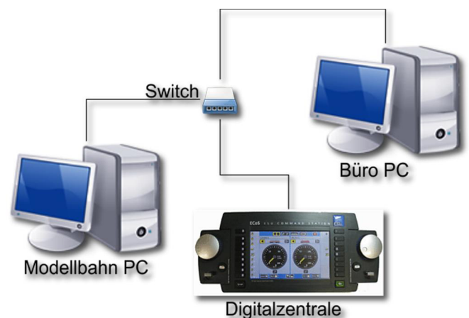
Abb. 3.4 Netzwerk mit mehreren Clients und einem Switch
