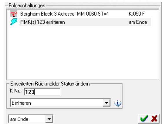
Abb. 7.96 Folgeschaltung „erweiterter RMK-Status“
