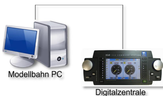
Abb. 3.3 einfaches Peer-to-Peer Netzwerk
