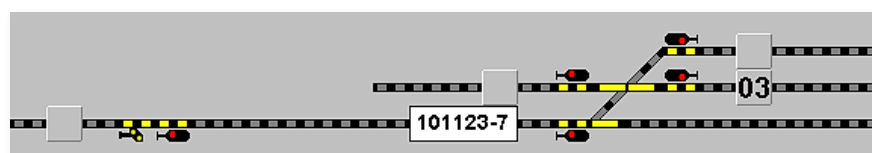
Abb. 3.75 Ein Fahrzeug-Anzeiger bestehend aus drei Symbolen dargestellt mit weißem Hintergrund
