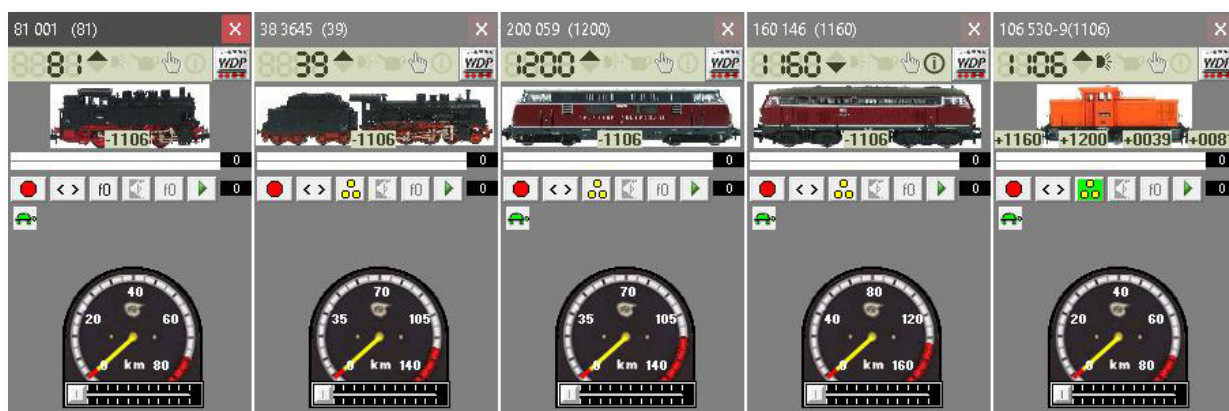
Abb. 16.65 eine Mehrfachtraktion mit insgesamt fünf Lokomotiven
