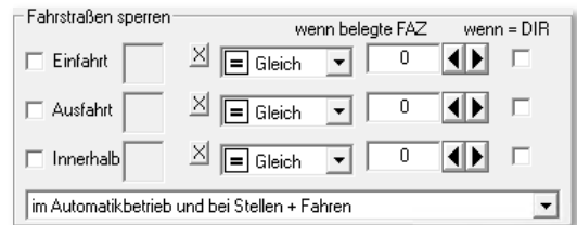
Abb. 11.23 Sperrung von Fahrstraßen im FDL-EXPERT
