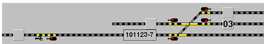
Abb. 3.74 Ein Fahrzeug-Anzeiger bestehend aus drei Symbolen dargestellt mit grauem Hintergrund
