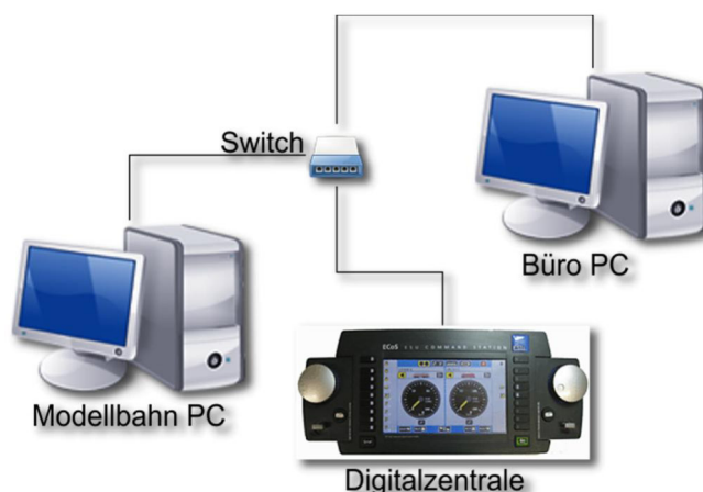
Abb. 3.4 Netzwerk mit mehreren Clients und einem Switch
