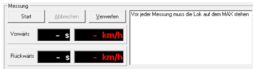
Abb. 4.38 Während einer Messung werden hier die ermittelten Werte dargestellt
