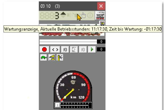
Abb. 5.1 Wartungsanzeige im Fahrzeug-Control
